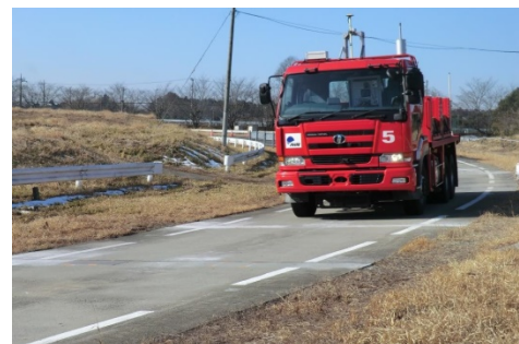
舗装走行実験施設による耐久性試験
