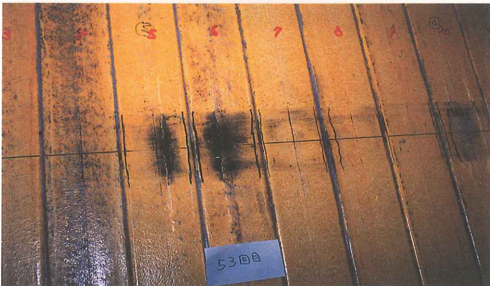
図-6・5・12 供試体1の荷荷面の状況(53サイクル目)
