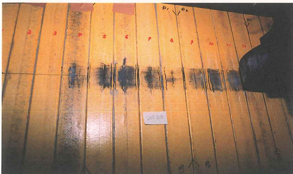
図-6・5・13 供試体1の荷荷面の状況(205サイクル目)
