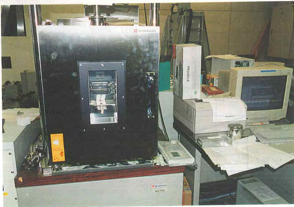
写真-3・2・2 曲げ疲労試験実施状況 (50℃)
