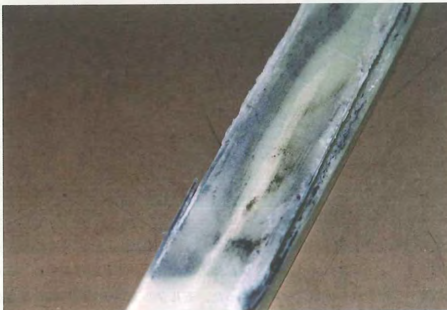
写真-3・2・4 載荷面上部のせん断破壊（輪荷重載荷）
