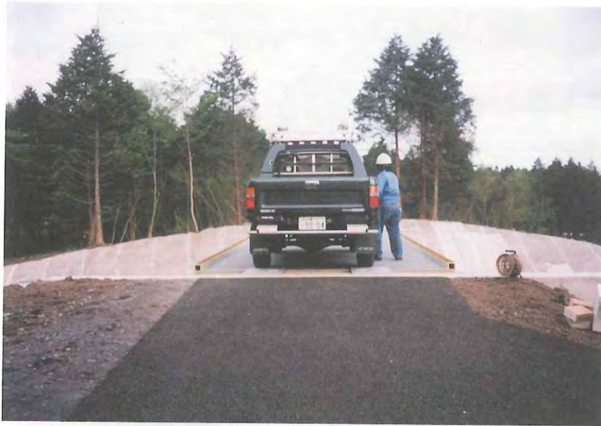
静的載荷試験 小型車による 載荷
