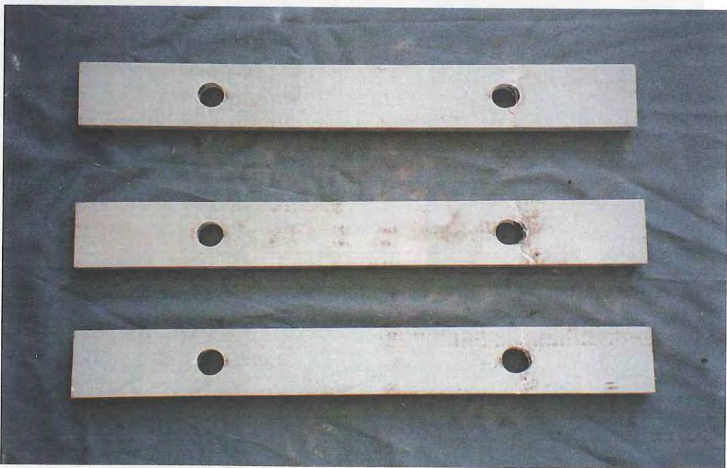
写真-6・3・4 M2 2ボルト試験体および破壊状況 - 円端距離 e 大、幅 w 中、引張破壊、接着なし -
