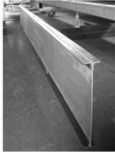
図 3.1.4 ウェブ+接合用アングルの接着
