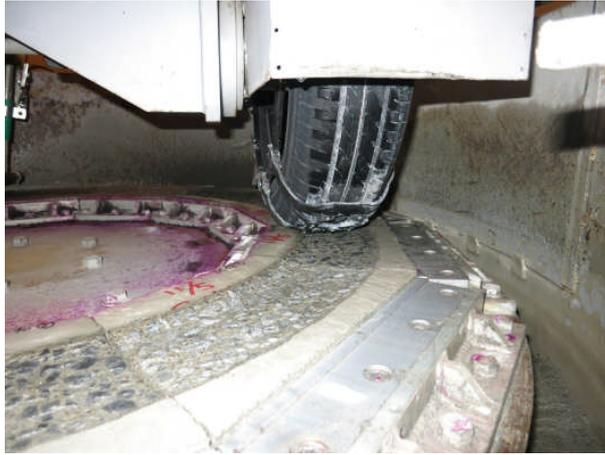
写真 4.4.2.1 回転ラベリング試験機
