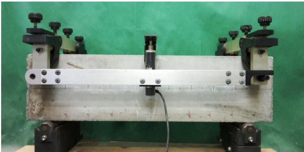
写真4.3.5.1 曲げ供試体にたわみ測定器具を装着した状態
