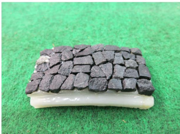
写真 3.5.1 PSV 試験用供試体
