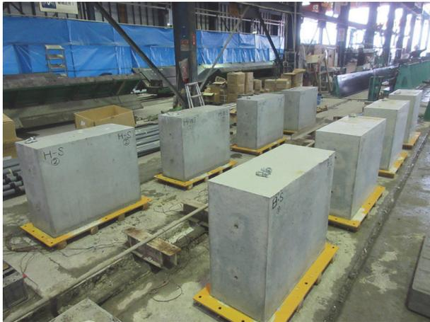
付写真-1 壁状供試体(脱型直後)
