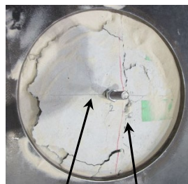
コーン状破壊 導入したひび割れ
