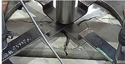
写真 4-8 割裂破壊の例
