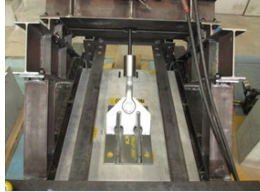
(b) 吊り金具の設置状況 (アンカー打設前)
