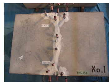
(c) ひび割れ注入完了
