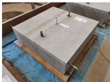
ひび割れの導入及びアンカーの打込み
