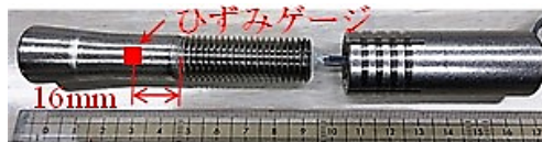
写真 4-10 ひずみゲージ埋込みアンカー (M16)
