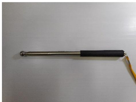
解説図-5.3.2 触診による調査に用いる器具の例〔被〕
