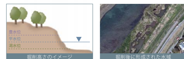
図1 揖斐川の調査区間と掘削高さの概要 掘削後に形成された水域には二枚貝が生息している
