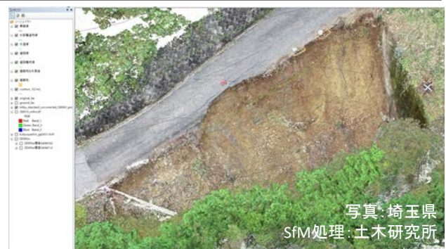
護岸被災箇所の詳細な3次元地形モデル (UAVで撮影した写真からSfMにより作成)
