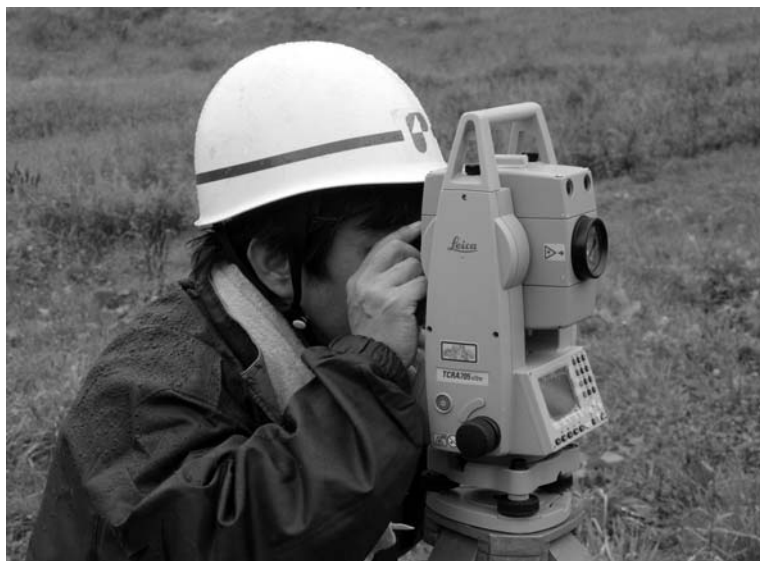
写真参－9 トータルステーションによる計測
