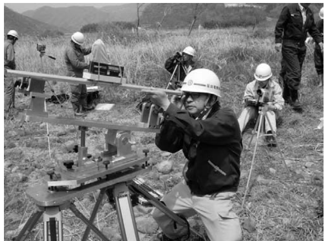
写真参－6 角度計による計測状況
