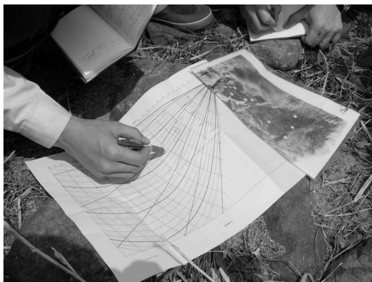
写真参－８ 仰角設定早見図による仰角の算出
