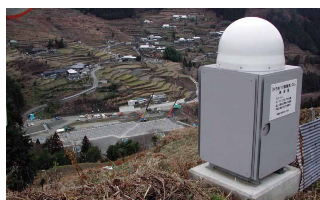
▲人工衛星 (GPS) による移動状況調査 Measurement of ground displacement by using GPS
