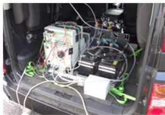
写真-2 排出ガス計測装置
