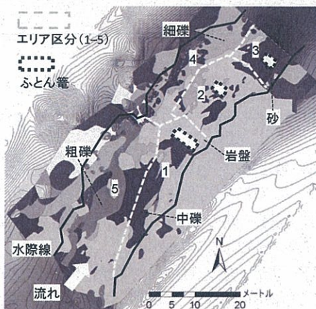
図-6 7月の河床材料調査の結果とふとん籠の位置
