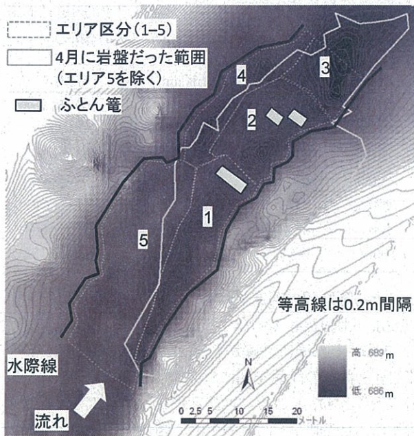
図-2 対象区間の微地形，籠設置箇所，調査エリア区分
