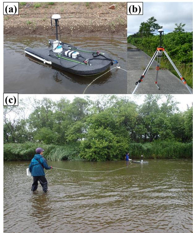
図-2 使用機器. (a) ADCP: SonTek River Surveyor M9, (b) RTK-GPS 型 PCM モジュール, (c) 計測状況.
