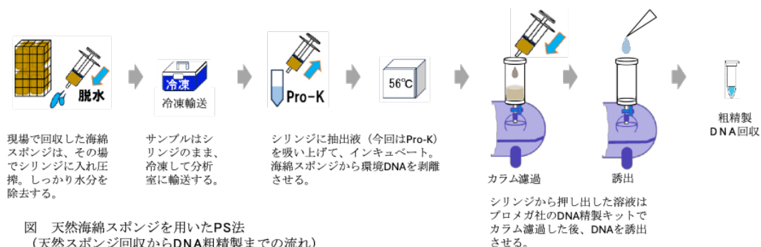
図 2.3-1 海綿スポンジから DNA を抽出する流れ
