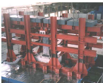
RC橋脚の耐震補強 に関する実験
