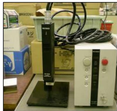
図-1 プラズマ照射器 ST-7000
