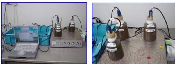
写真-1 底泥酸素消費速度試験
