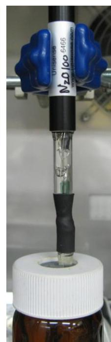
写真3 センサー挿入部
