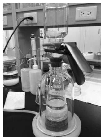
図2 吸引ろ過装置の外観図
