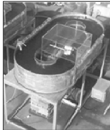
図-1 上部開放レースウェイ型培養槽
