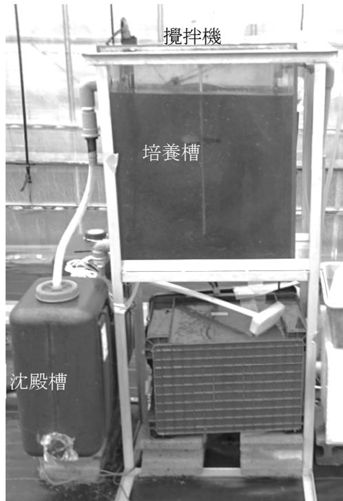
図-1 密閉縦型藻類培養装置
