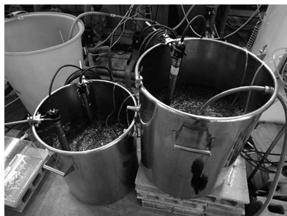
写真-1 微生物保持担体処理槽の外観
