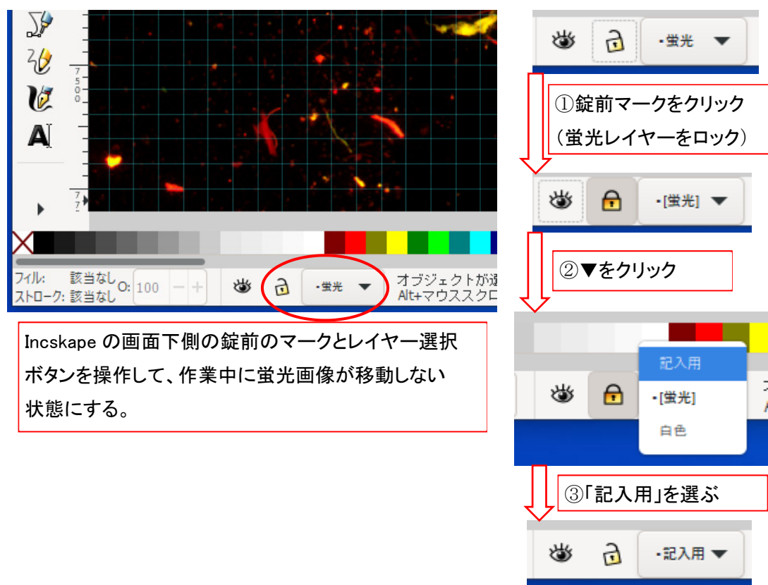
図-7.5 Inkscape のレイヤー操作（蛍光レイヤーの固定と記入用レイヤーに切替）の説明
