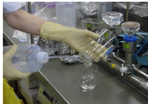
4) ファンネルの壁面を洗ってビーカー に洗い液を溜める
