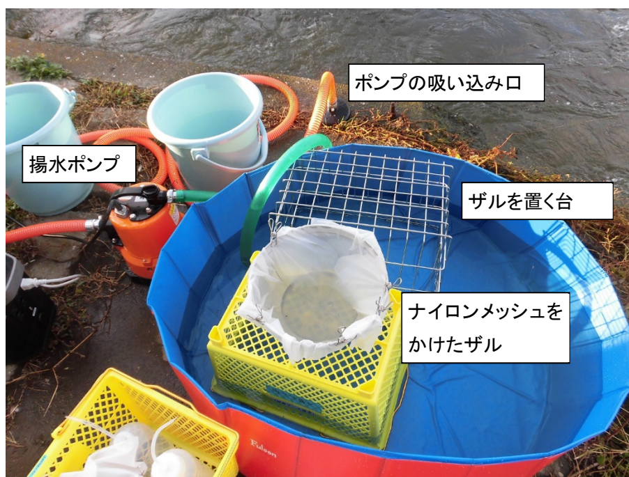
図-3.2 繊維状マイクロプラスチック回収機材の一例
