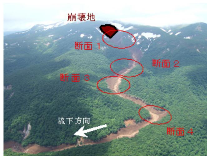
図 3 土石流の流下域の状況と各断面の位置図
