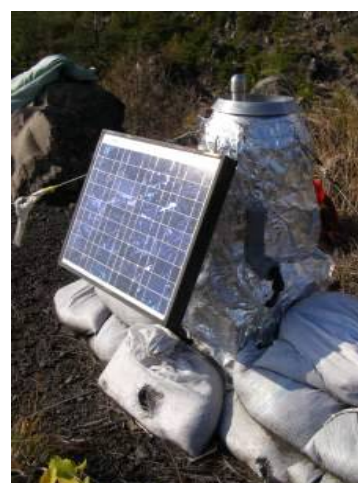
写真1 自動降灰量計の外観
