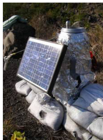
写真 1 自動降灰量計の外観
