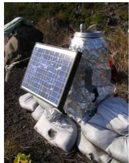
写真1 自動降灰量計の外観
