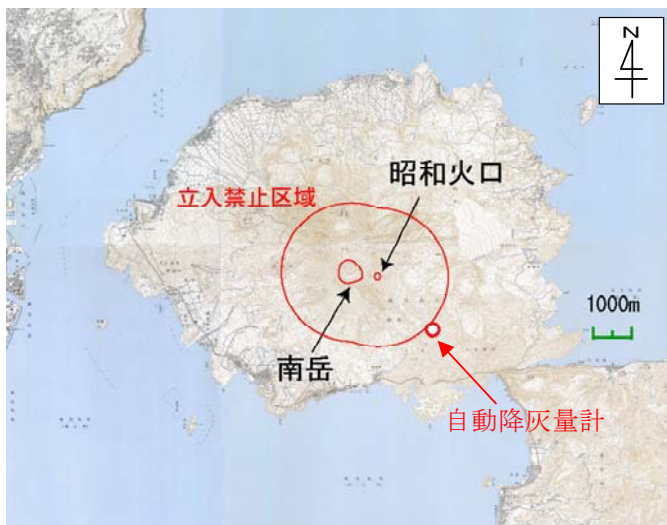
図1 自動降灰量計設置位置図 (北緯31° 33' 57.28"、東経130° 40' 49.24" )
