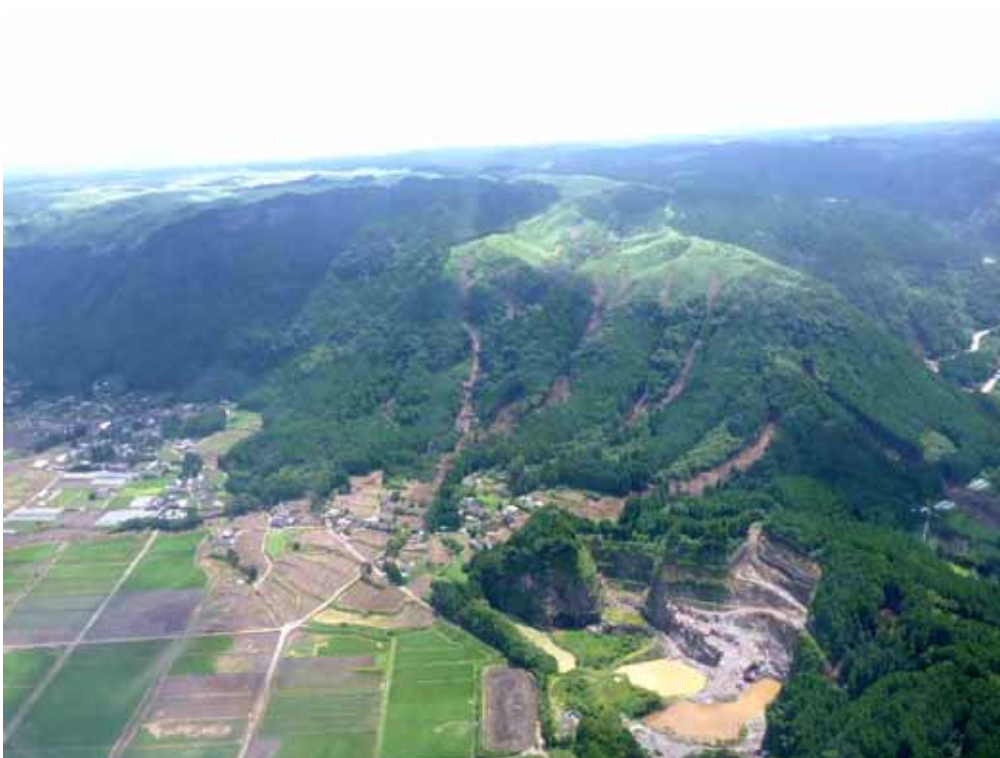
坂梨北地区。卵の鼻の北西の斜面に崩壊が集中している。
