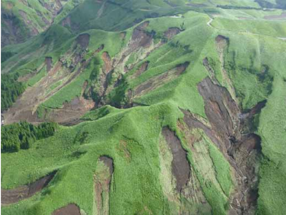
根子岳方向を望む。広い範囲で植生のない崩壊地が分布するが、植生の薄い部分も確認できるため、1990 年災害時からの継続崩壊も多く含まれるものと思われる。
