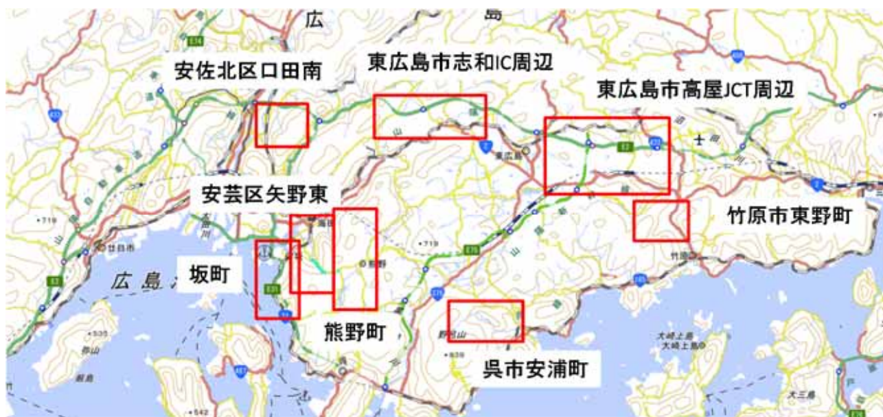
図 - 2 土石流が集中して発生していた地域，図・1 より狭い範囲を示している
