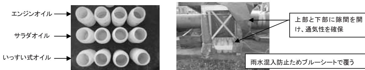
図 2.2.3.17 オイル膜による水分蒸発防止効果の野外試験状況
