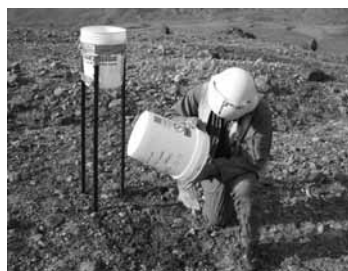
図2.2.1.11 三脚と二重に重ねたバケツの設置および回収状況 9)
