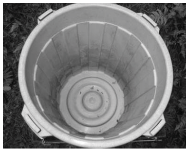
図 2.2.1.1 降灰観測容器写真 (左：中身、右：正面)
