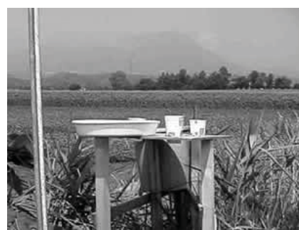
図 2. 2. 1. 5 火山灰トラップ設置状況 1) (紙コップと洗面器が設置してある)
