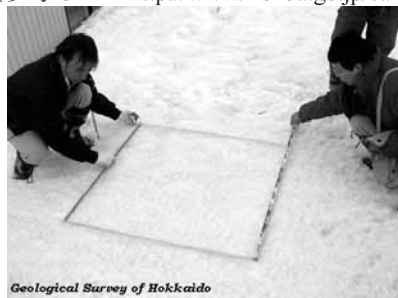
図2.2.1.9 北海道立地質調査所の定面積サンプリングの様子 6)
