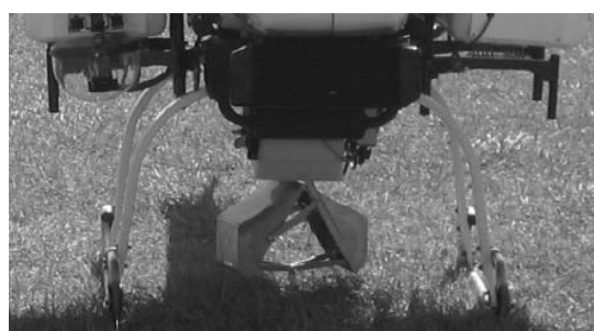
図 2.3.2 北海道開発局が開発した試料採取装置の仕様と実際に装備したときの写真 (機体中央下部に見えているカニばさみが試料採取用のバケット)
