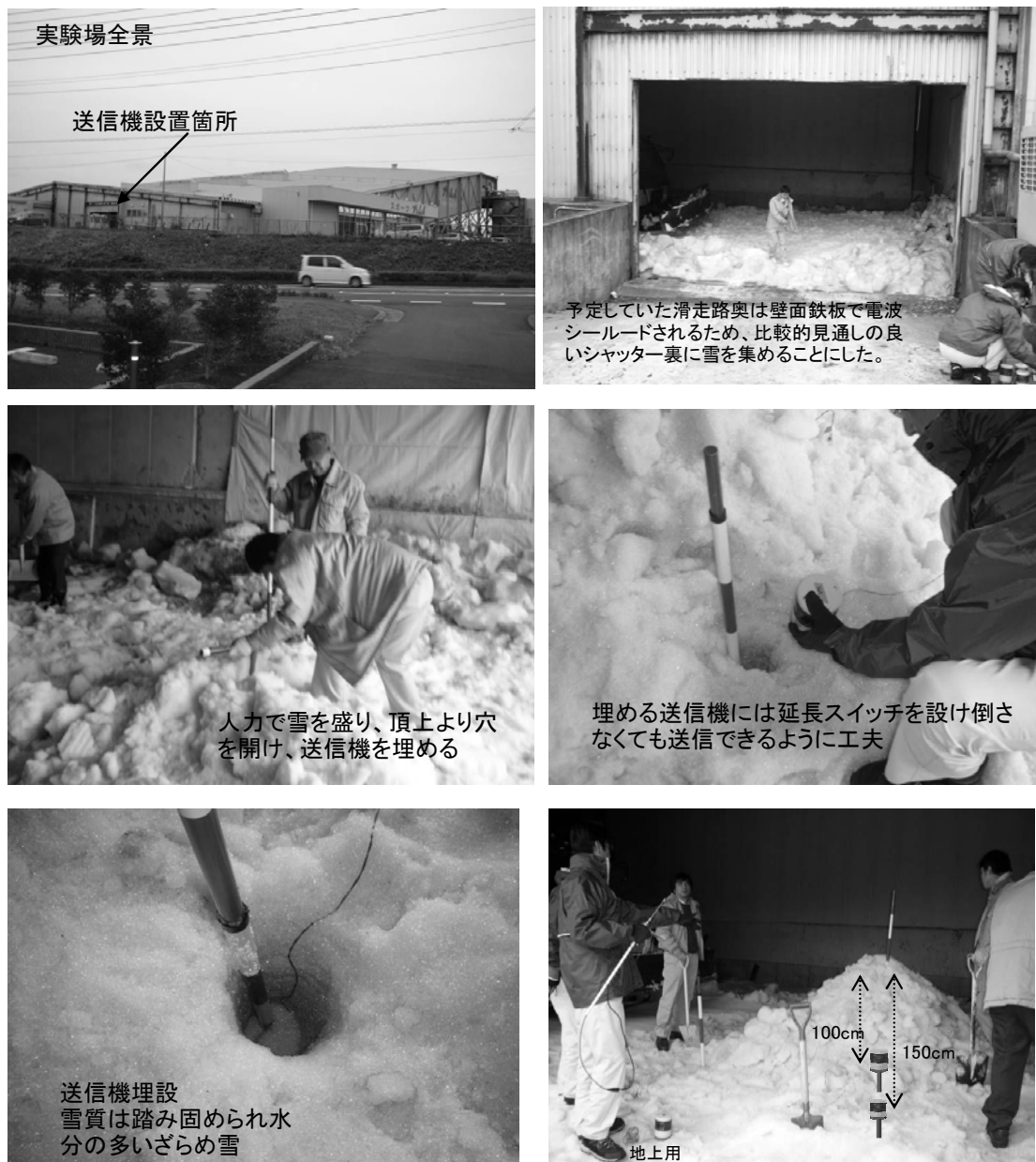
図-2 積雪下センサーによる無線伝送試験
