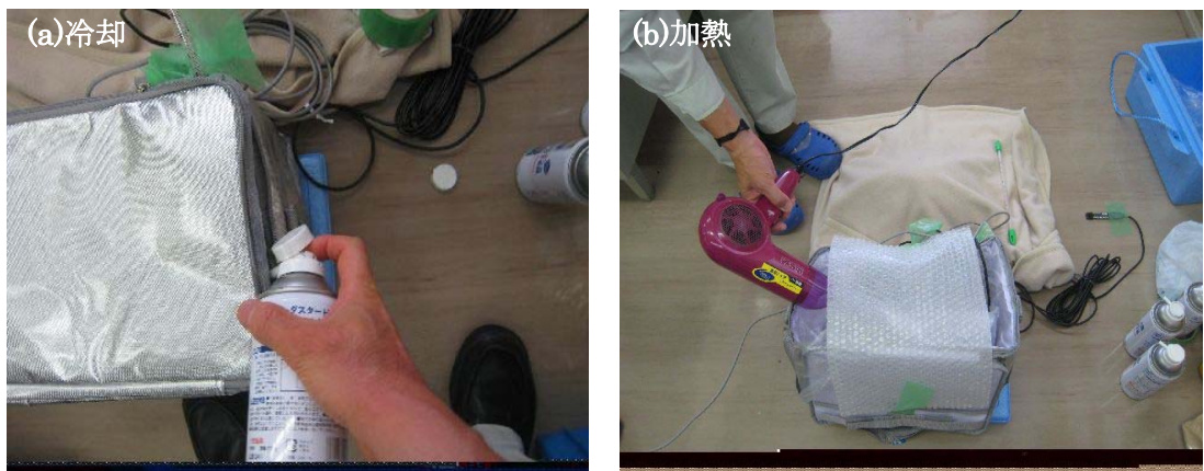
図ー2 温度特性試験の冷却・加熱状況
