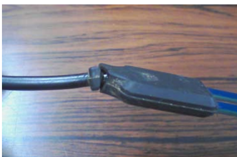
図-3 動物の仕業により土壤水分計の基板根元が折れ浸水
