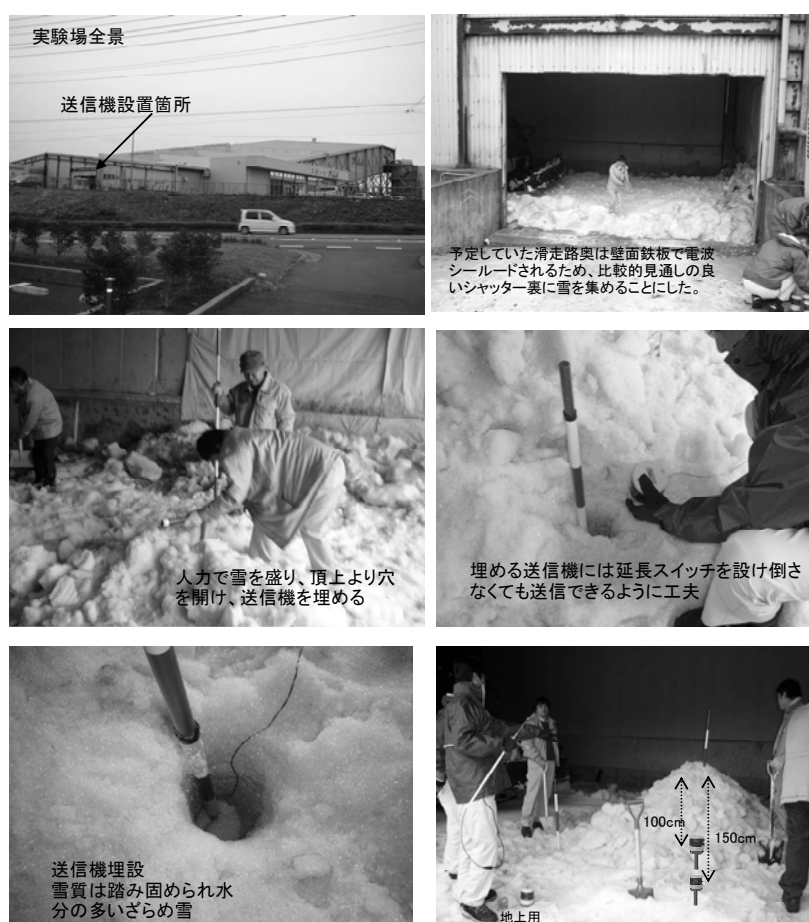
図 3. 9 積雪下センサーによる無線伝送試験
