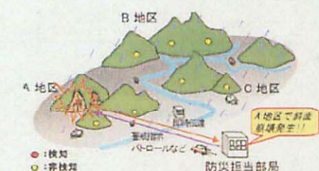
図-1 斜面崩壊検知センサーを用いた土砂災害に対する警戒避難のイメージ
