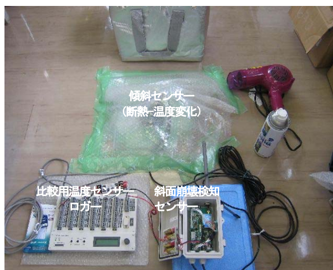
図 3. 4 温度特性試験の設置状況
