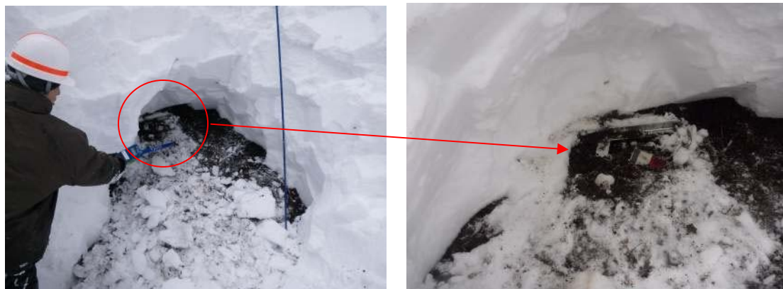
写真-1 雪圧により傾斜したタイプVセンサー状況
