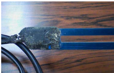
図-2 土壤水分計の基板部が動物に噛まれた跡
