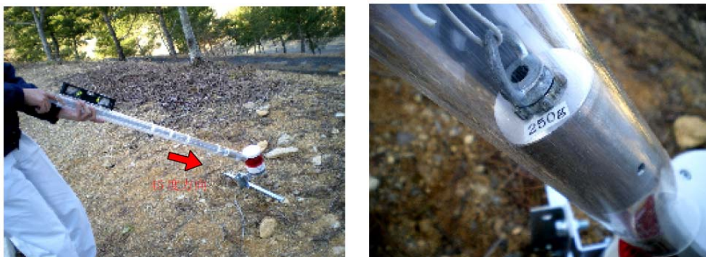
写真-2 衝撃試験状況
