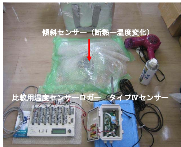
図—1 温度特性試験の設置状況
