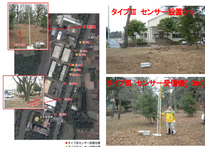
図3.7 樹木林立の条件下における通信試験
