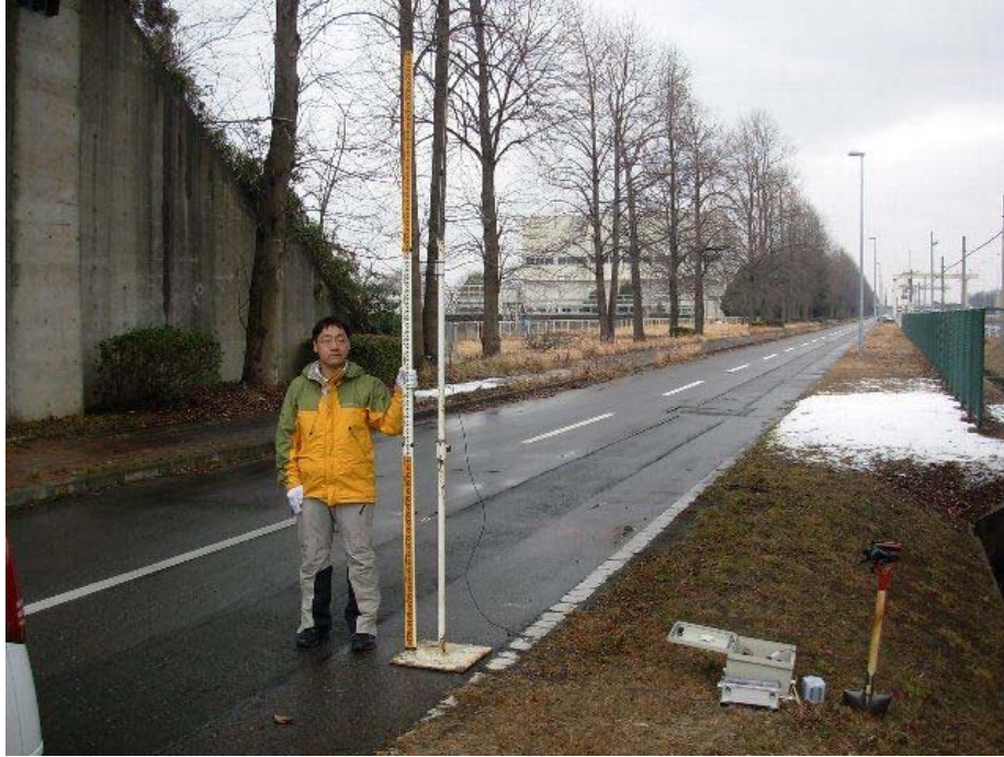
図-3 タイプⅢセンサー 受信制御装置（アンテナ高さ 3m）
