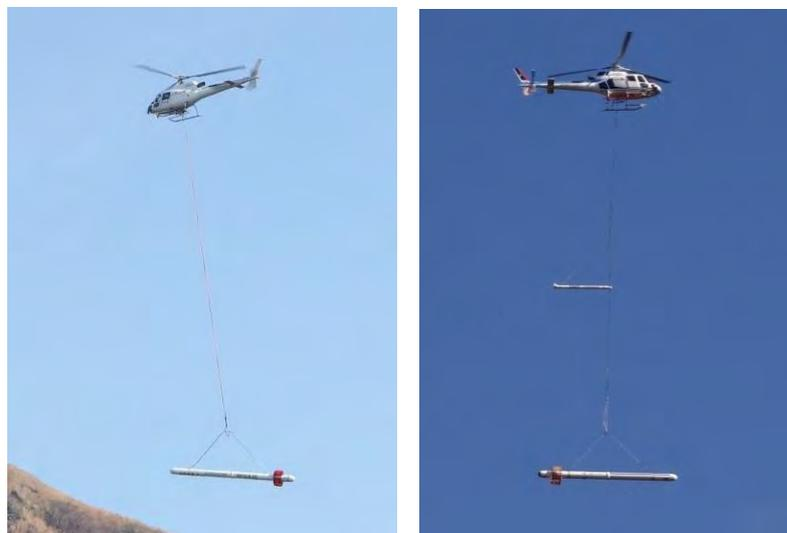
図 16 空中電磁探査の実施状況（左：RESOLVE タイプ 右：DIGHEM タイプ）
